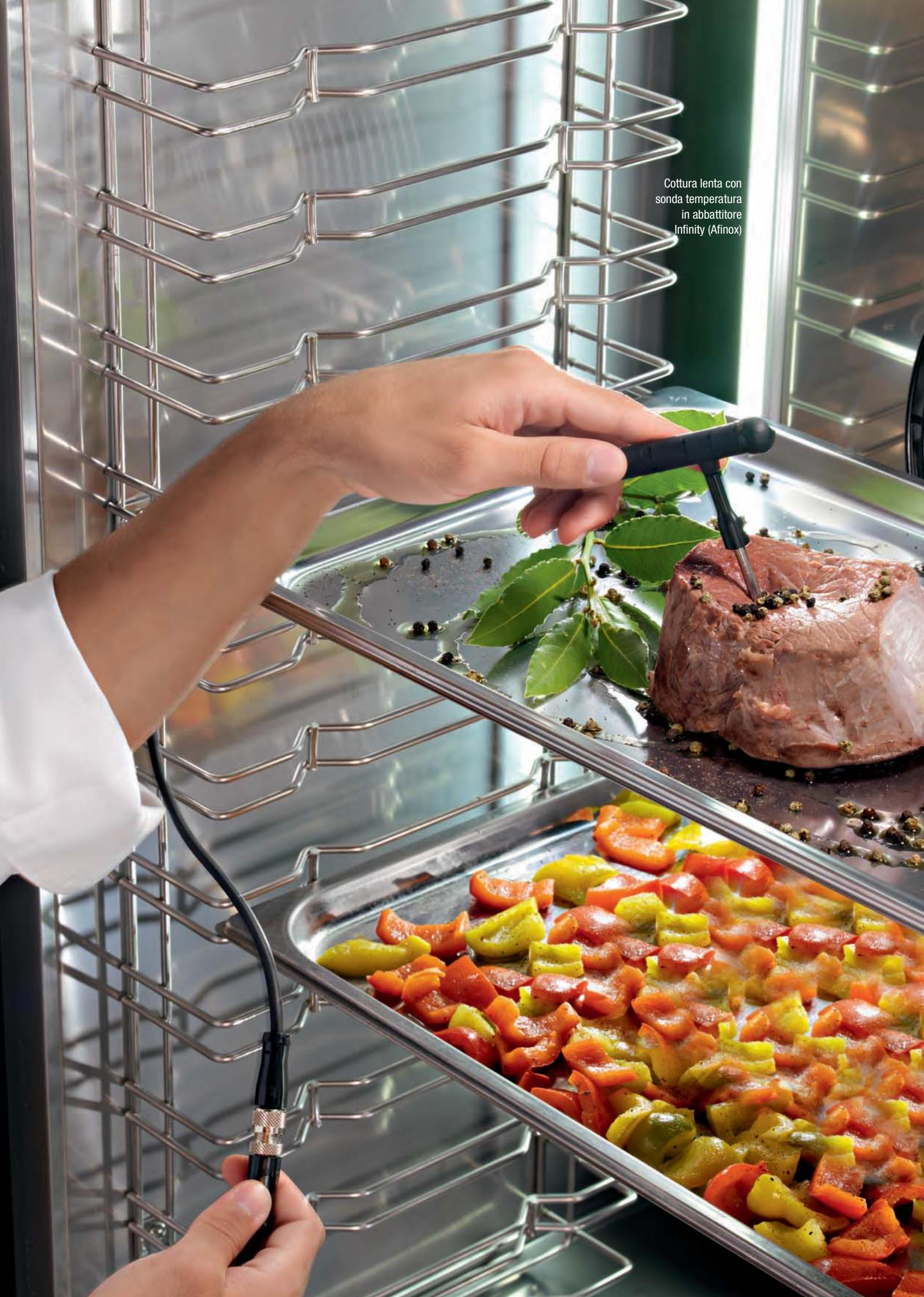
Funzione Multilevel dell'abbattitore di temperatura Infinity (Afinox): per gestire correttamente la temperatura delle diverse teglie, assicurando la qualità dei prodotti.
