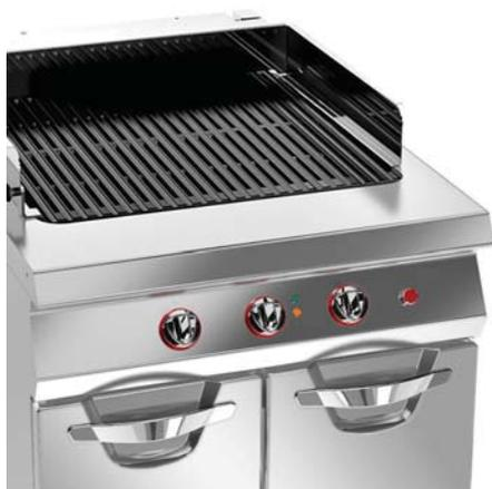
La Griglia Elettrica Angelo Po ha un piano in acciaio inox AISI 304, spessore 20/10. La griglia di appoggio prodotto è in ghisa smaltata. Il riscaldamento avviene con 2 batterie di resistenze indipendenti ribaltabili. Il riempimento della vasca avviene tramite pulsante ed è possibile il collegamento diretto alla rete idrica.
